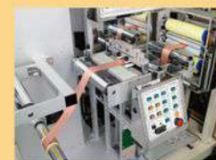
自動張力控制系統， 最適合對應超薄材。
