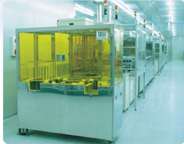
乾燥自動線 Auto Drying Line ● 適用電阻式觸控面板製程。
