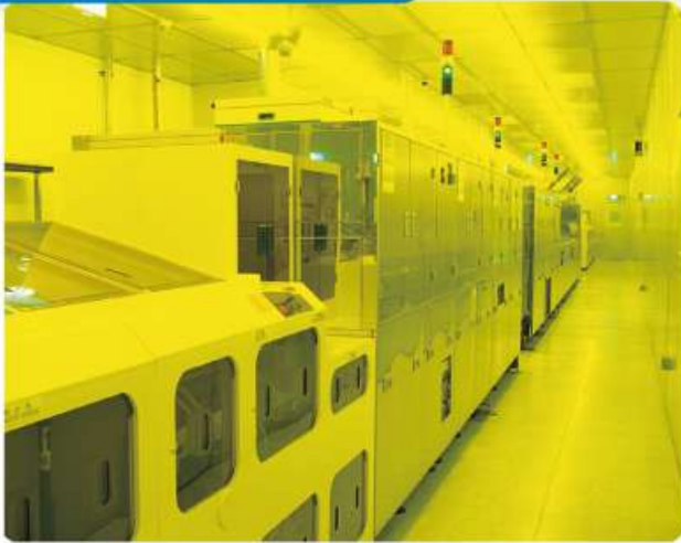
黃光自動線 Photo Line ● 適用LCD及電容式觸控面板製程。
